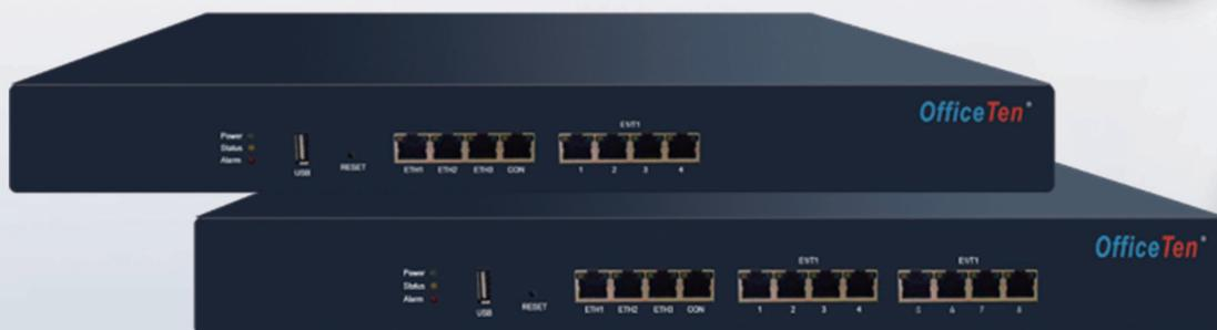
TG2800 是针对企业、行业和运营商等推出的中继网关产品，系统采用媒体网关和信令网关一体化设计，支持 PRI、R2、SS7 信令与 SIP 信令的转换，同时完成 TDM 语音交换与 VoIP 之间的媒体流转换。系统采用成熟的硬件结构及先进的 DSP 语音处理技术，使用嵌入式操作系统和高效的算法，支持多种语音编码技术，具有语音清晰、保真度高的特点，是具备先进技术和高性价比的产品。
